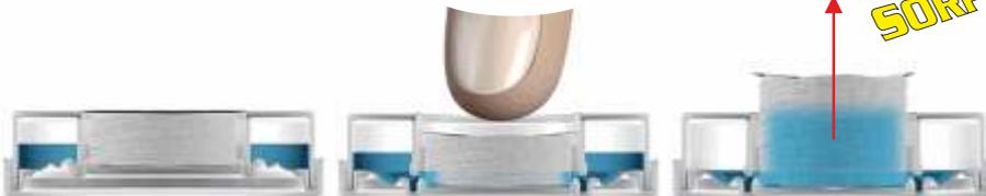
Al aplicar presión en el centro de la cápsula la válvula inferior se abre liberando el fluido de la cámara exterior alcanzando la cámara interior donde se encuentra la toallita comprimida, esta absorbe completamente el fluido y se expande verticalmente sola. Una vez expandida la retiramos de la cápsula y la desplegamos para su uso.
